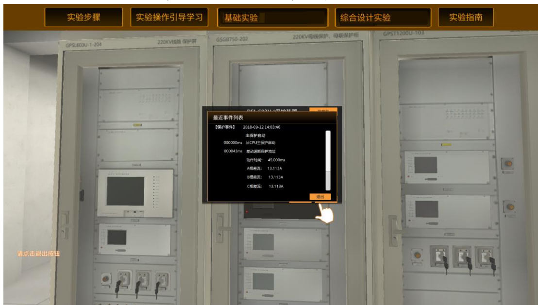
图 21 模拟保护装置面板触摸屏差动保护动作信息图
