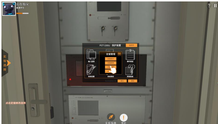
图 12 保护装置定值管理 LCD 界面图
