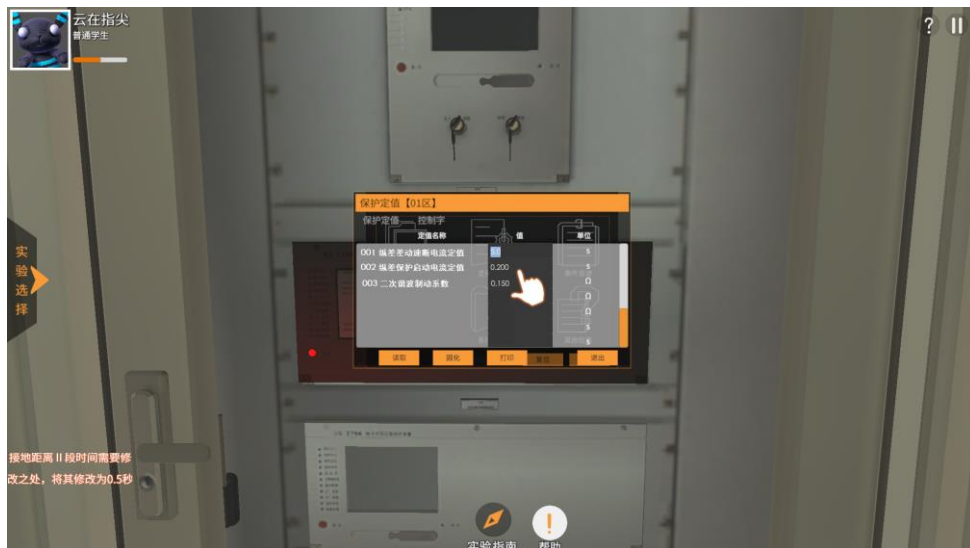
图 14 保护装置定值修改 LCD 界面图
