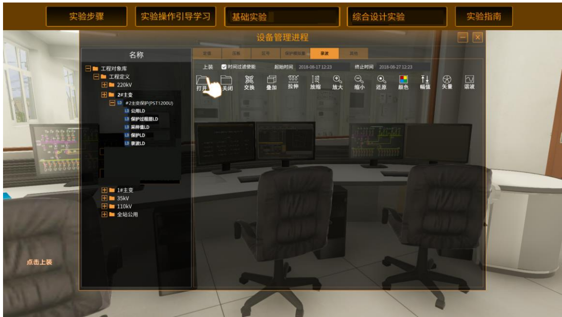
图 24 保护装置录波数据上装界面图
