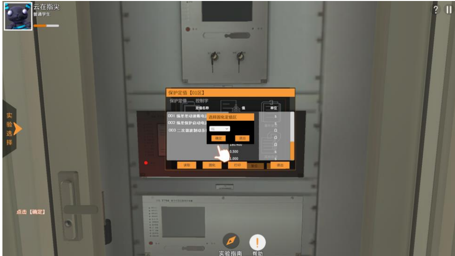
图 15 保护装置固化定值区界面图
