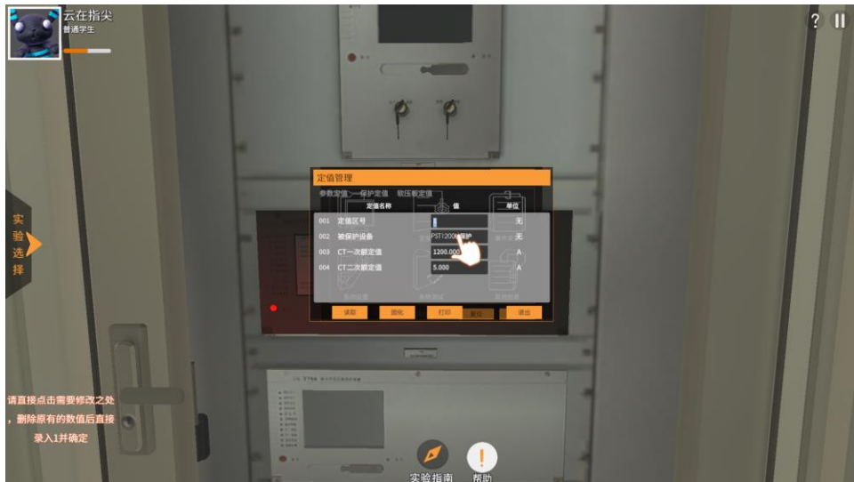
图 13 保护装置定值读取 LCD 界面图
