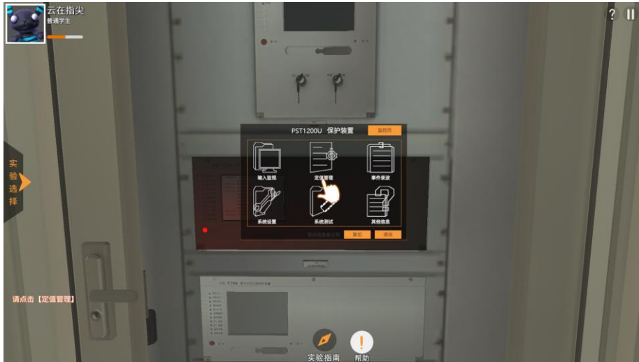
图 11 虚拟保护装置 LCD 界面图
