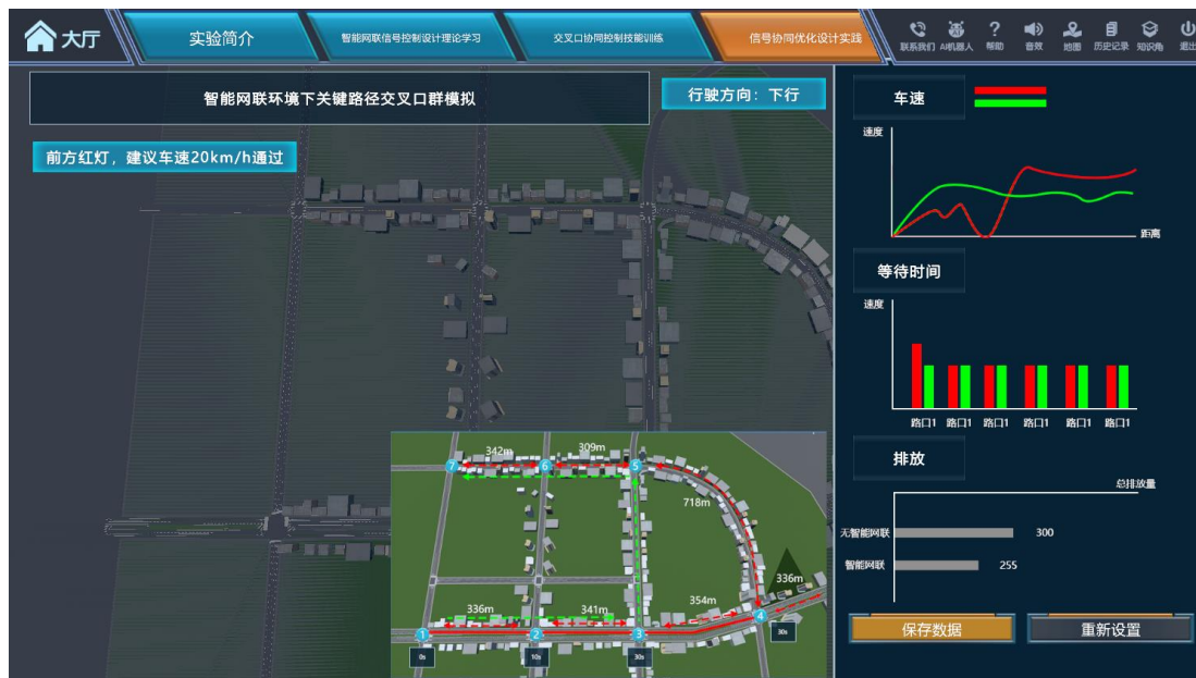
(f) 真实路网智能网联场景下交叉口信号控制方案驾驶模拟
