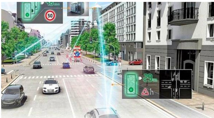
图 5 智能网联场景下交叉口信号配时、行驶速度协同控制示意图
